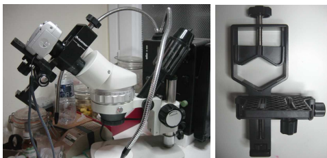
Adaptador universal + detalle. Fotografía: xauxa
