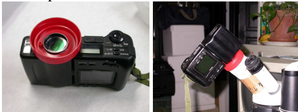
Tapadera cortada a la medida del objetivo y colocada sobre el ocular de la lupa Fotografía: Ale.
